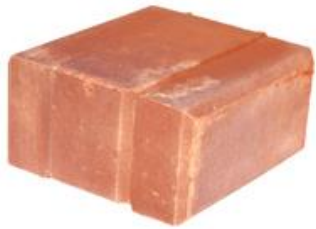
BTC : Bloc de Terre Comprimée
